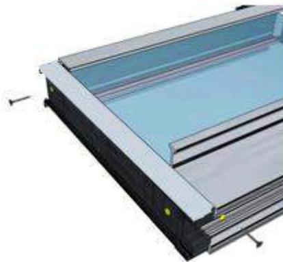
10.- En el horizontal inferior (antes de atornillar), se introduce también el perfil de rodadura ref.: 10968, para posteriormente, proceder a su atornillado y fijación rígida. Bastará ser atornillado únicamente con el tornillo del kit de las tapas de unión.
