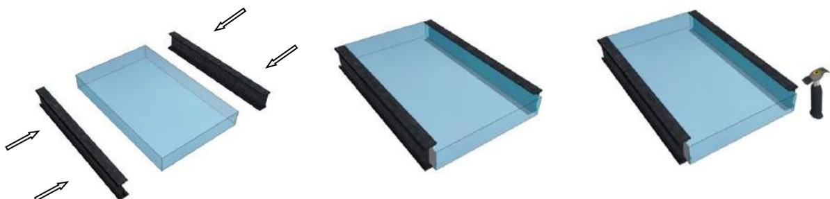
4.- Apretar dando presión a la poliamida sobre el vidrio mediante martillo de nylon o similar con ligeros golpes para asegurar la perfecta unión y adherencia entre las partes con la cinta 3M VHB G/23F.
